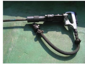
3. ハンマードリル (岩盤を穿孔する)
