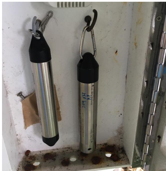
湿原テラスに既設されている百葉箱内に 設置した大気圧兼気温計（右）
