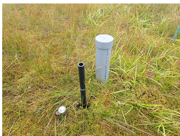
地下水位計パイプ（右）と 地温計パイプ（左） （八幡沼湿原）
