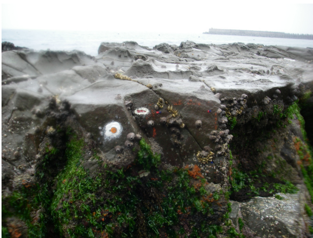
設置した温度ロガー(中央左寄り)。このデータから水温変動と波当たり強度の推測を行う
