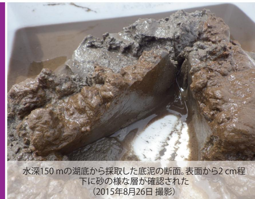
水深150 mの湖底から採取した底泥の断面。表面から2 cm程下に砂の様な層が確認された
