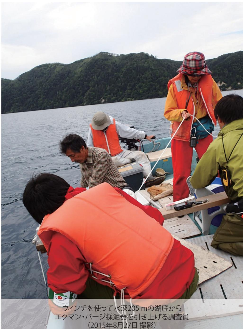
ウィンチを使って水深205 mの湖底からエクマン・バージ採泥器を引き上げる調査員
