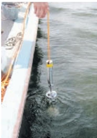
【湖沼調査】湖底の水を採取する「北原式採水器」
