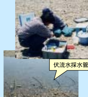
伏流水採水管による水質調査
