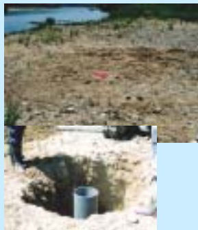
着色土砂柱による土砂移動の調査
