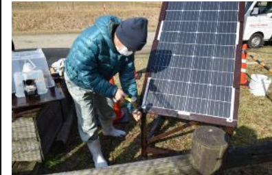
ソーラーパネル駆動式の営巣地モニタリングシステム
