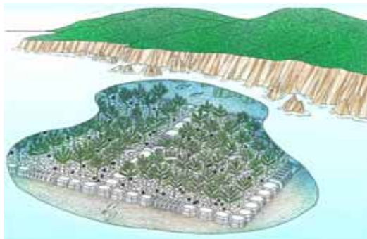
自然石やコンクリートブロック等の着定基質の設置により藻場の造成
