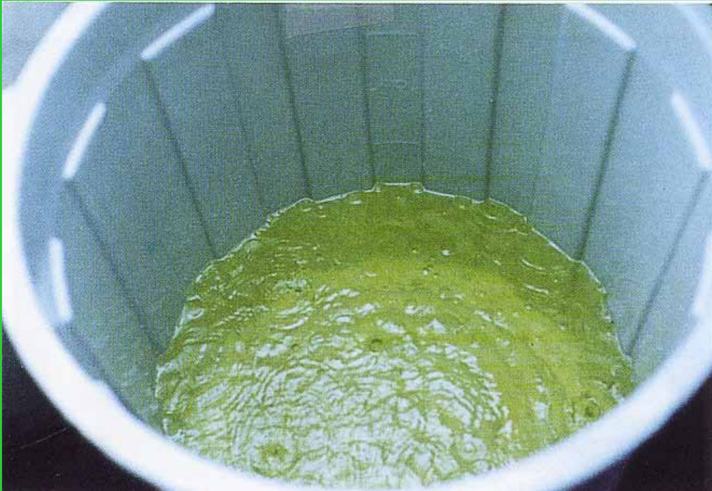
地中から回収した汚染物質(テトラクロロエチレン)
