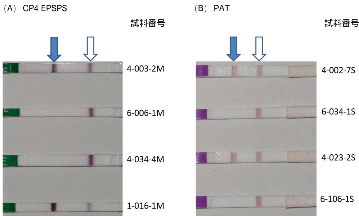
図2 免疫クロマトグラフ法によるグリホサート耐性タンパク質 CP4 EPSPS(A) 及びグルホシネート耐性タンパク質 PAT(B) の検出の例
