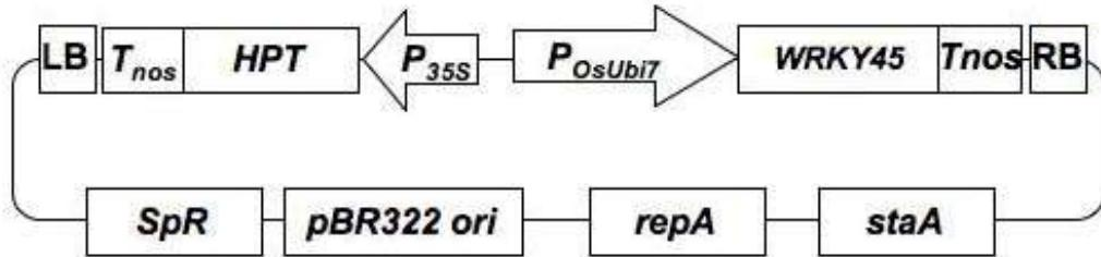
図 1 本遺伝子組換えイネ作出に用いた形質転換用プラスミド（バイナリーベクター）の構造
